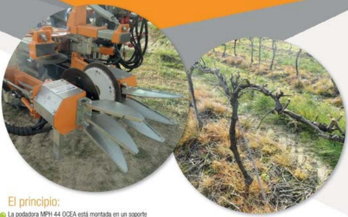
La podadora MPH 44 OCEA está montada en un soporte de máquina SMD 50 de doble viga con altura (700 mm), traslación (500mm) e inclinación hidráulicas. Los 4 módulos de corte están equipados de sierras (450 mm) accionadas por motores hidráulicos. Las sierras realizan un corte lateral (módulos delanteros) y horizontal (módulos posteriores).
